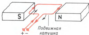
Рис. 54. Вращение витка катушки в магнитном поле
